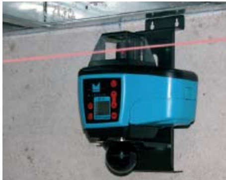
Obrázek 9 rotační laser Mikrofynd upevněný pomocí standardního držáku pod stropem
