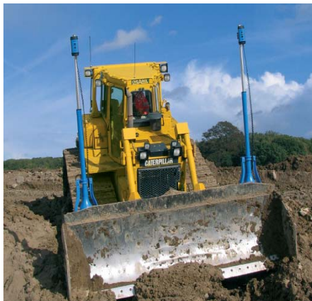
Obrázek 24 pásový buldozer pracující v systému MikroDozer™ s přijímači MD 10 upevněnými na stožárech EM 4
