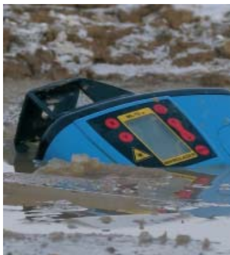
Obrázek 28 laser Mikrofyn v neobvyklých podmínkách (po očištění od bláta okamžitě fungoval) - IP 68
