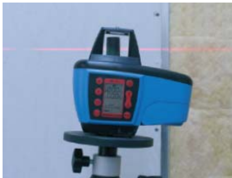
Obrázek 1 automatické urovnání laserového přístroje Mikrofynd ML 14i do vodorovné roviny (rozsah samourovnání \pm 5^\circ od vodorovné roviny)
