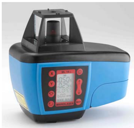
Obrázek 20 Mikrofyn ML 14 s možností nastavení sklonu v ose X 0% - 10%, v ose Y 0% - 10%; pracovní dosah 300m
