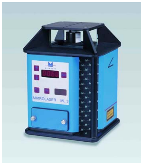
Obrázek 19 Mikrofyln ML 3 s možností nastavení sklonu v ose X 0% - 10%, pracovní dosah 800m
