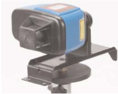
Obrázek 8 laser Mikrofynd ML 14i uchycený pomocí standardního držáku k výsuvnému stativu (měření svislé roviny)
