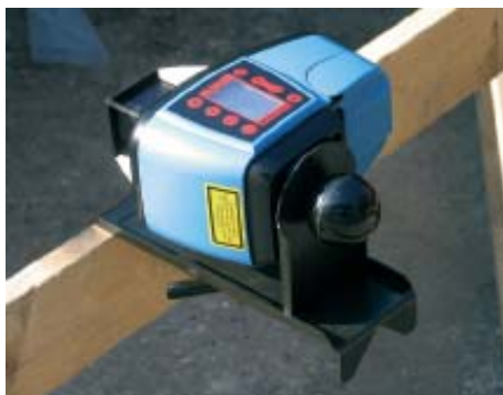
Obrázek 7 laser Mikrofynd ML 14i uchycený pomocí standardního držáku k bedněni a připravený pro měření svislé roviny
