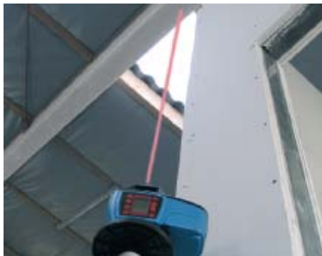
Obrázek 10 rotační laser Mikrofynd ML 14i vysílající paprsek kolmý k dané rovině
